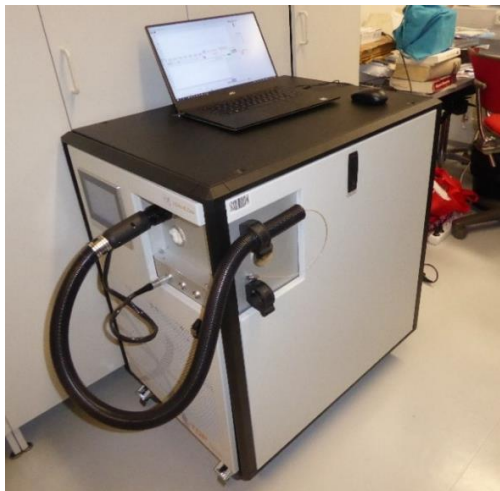
Kuva 9. Mittalaitteena käytettiin reaaliajassa toimivaa massaspektrometriä PTR-TOF-MS: Proton-Transfer-Reaction Time-Of-Flight Mass Spectrometer (protoninsiirtoreaktiolentoaikamassaspektrometri).
